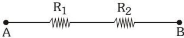
La tensión entre los puntos A y B se reparte directamente proporcional a los valores de las resistencias  $R_1$  y  $R_2$ . En cambio si se tiene un circuito paralelo.
