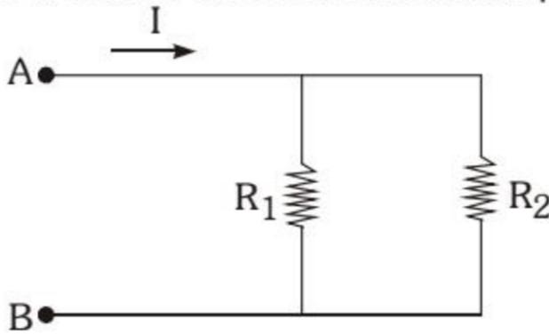
La corriente  $I$  se reparte inversamente proporcional a los valores de las resistencias  $R_1$  y  $R_2$ .
